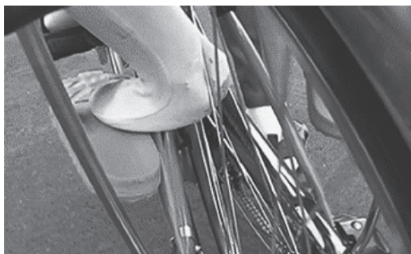
図4 足の踵部が車輪に巻き込まれる写真（文献3より引用）
