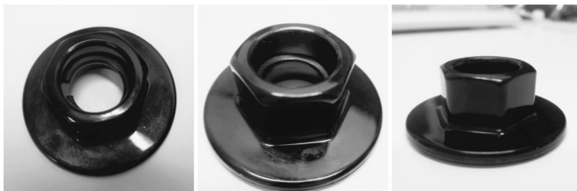
図5 指にはまったおもちゃの実際の写真。ナットの内径（直径）は13mm、高さは12mmであった。内面はねじを締めるために螺旋状の突起があった。
