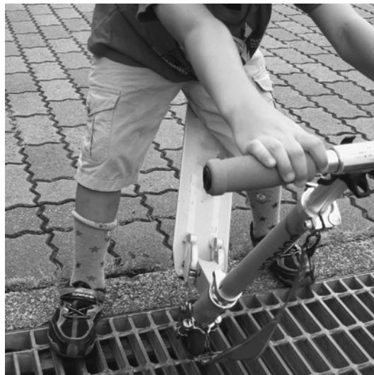
図3 キックスコーターの前輪がグレーチング(側溝)にはまりバランスが崩れる(参考写真)。モデルは事故を起こしたものと異なる。
