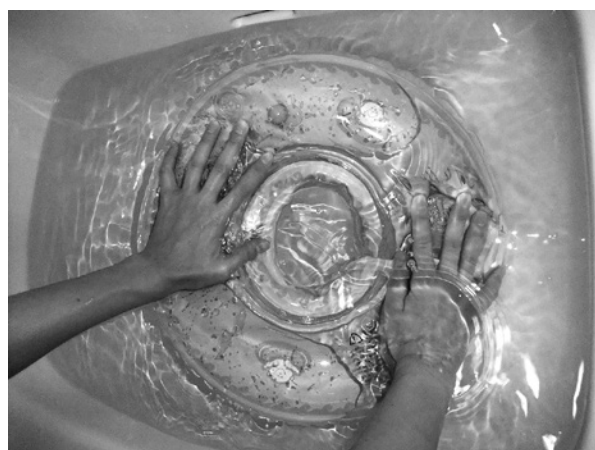
写真2 上面を上にして浮き輪を沈めると、極僅かに空気の漏れが認められる。
