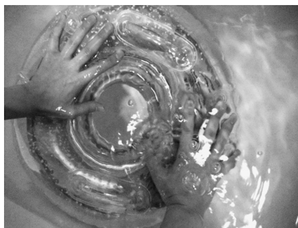
写真3 下面を上にして浮き輪を沈めると、僅かに空気の漏れが認められる。
